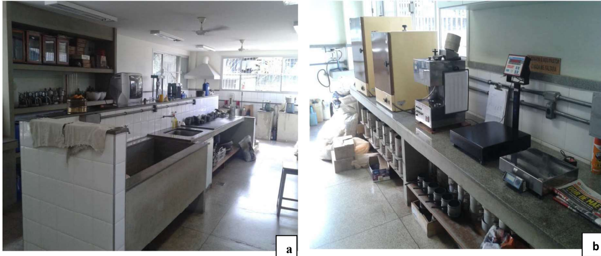
Figura 2. Laboratório do DER/ES (a) tanque de compactação e (b) balanças e estufa.
